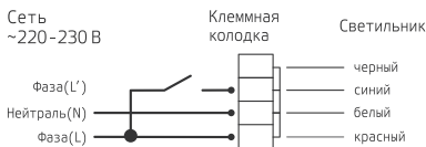
Рис. 2. Схема подключения светильника (непостоянный режим)
