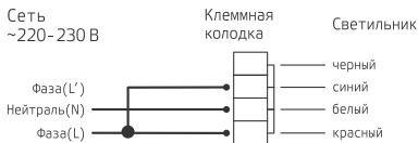
Рис. 1. Схема подключения светильника (постоянный режим)
